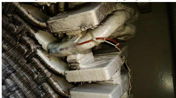
Рис. 6 Акселерометры вибрации лобовой части (ВЛЧ).
