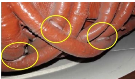
Рис. 11 Межфазный ЧР в лобовой части обмотки - образование белого налета в результате выделения озона.
