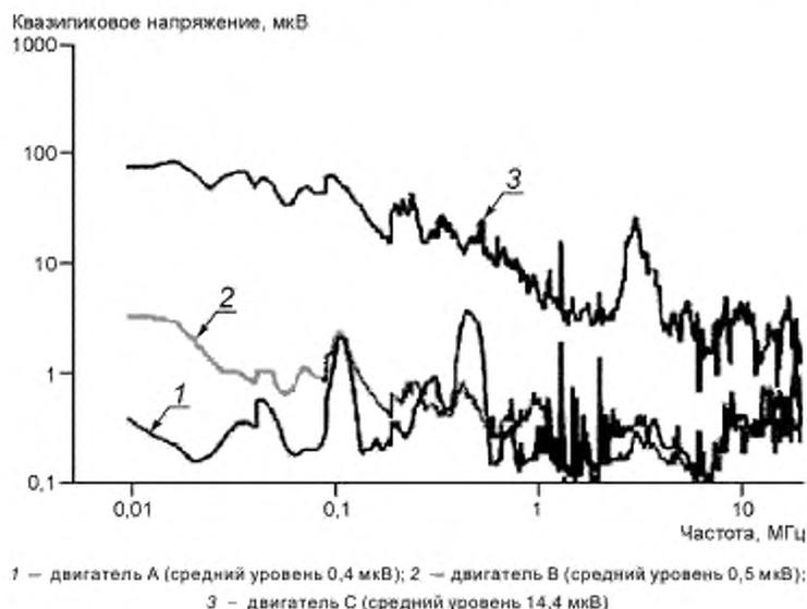
Рисунок 13 — Спектр электромагнитных помех двигателя циркуляционного насоса (13800 В, 4413 кВт, 324 мин<sup>-1</sup>)
