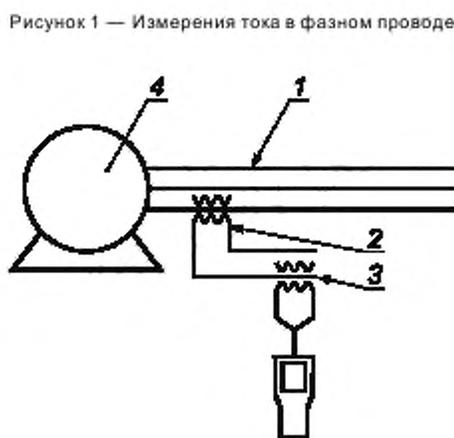
1 — фазный провод; 2 — токовый зонд; 3 — токоизмерительные клещи; 4 — двигатель с короткозамкнутым ротором
