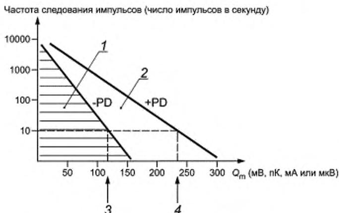
1 — частота следования импульсов отрицательной полярности (-PD) с пиковым значением меньше заданного; 2 — частота следования импульсов положительной полярности (+PD) с пиковым значением меньше заданного; 3 — значение  $Q_m$  для импульсов отрицательной полярности для частоты следования 10 импульсов в секунду; 4 — значение  $Q_m$  для импульсов положительной полярности для частоты следования 10 импульсов в секунду
