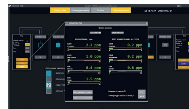
Пример вывода данных в ШАРМ, получаемых в онлайн-режиме от газового поточного хроматографа
