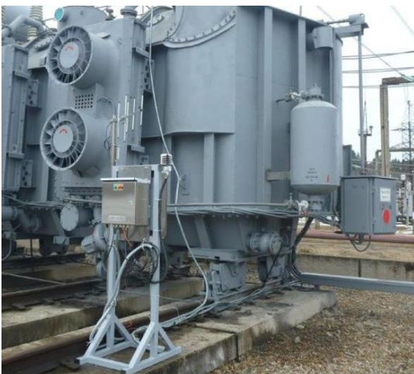
Мобильный (переносной) комплекс контроля и технической диагностики силовых трансформаторов
