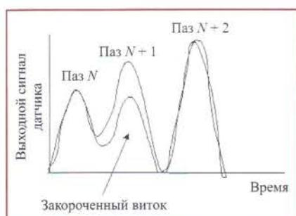
Рис. 6. Анализ данных магнитного потока с указанием закороченных витков обмотки ротора генератора
