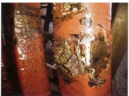
Рис. 22. Повреждение покровной ленты и начало истирания изоляции верхних стержней, вынутых из паза при обследовании повреждённого стержня
