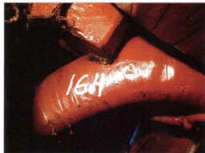
Рис. 25. Смятие и истирание изоляции стержня 16Н со стороны возбудителя межслойевой колодкой
