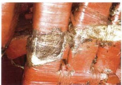
Рис. 21. Повреждение изоляции нижнего стержня фазы В межслойевыми колодками
