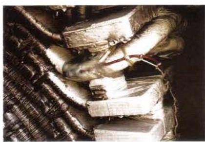
Рис. 7. Пример монтажа акселерометра в лобовой части статора генератора
