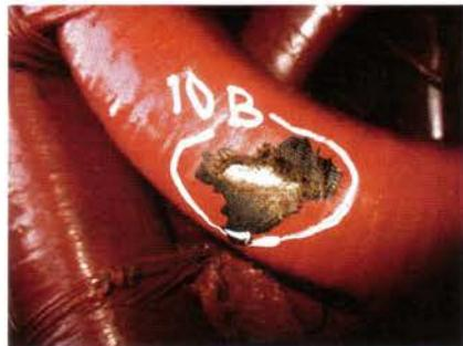
Рис. 23. Повреждение изоляции стержня посторонним предметом
