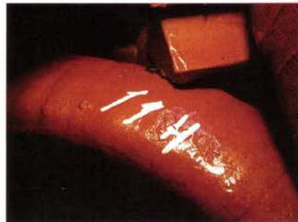
Рис. 24. Истирание изоляции стержня 11Н со стороны возбудителя межслойевой колодкой
