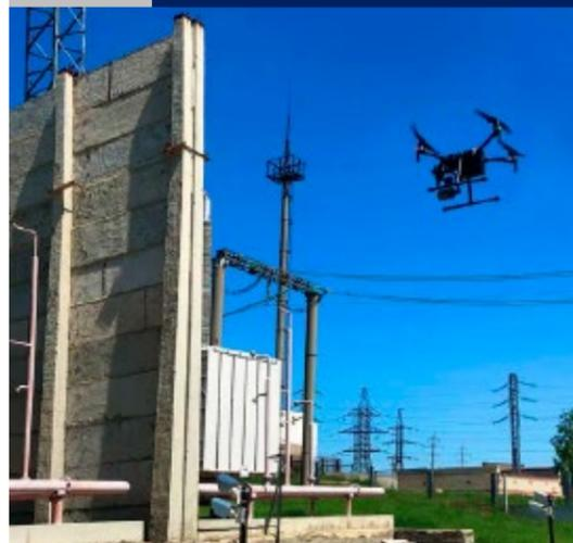
**ПТК автоматизированного визуального осмотра и наблюдения за состоянием оборудования ПС**
