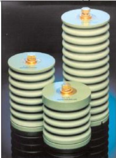
ЭСД стационарно устанавливаются (минимум один на каждую фазу) как можно ближе к исследуемому оборудованию для достижения максимальной чувствительности. Для улучшения выделения шумов, ЭСД устанавливаются направленно или дифференцированно, в зависимости от оборудования.
