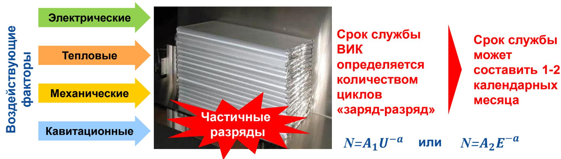
Разрушение внутренней изоляции конденсаторов связано, главным образом, с критическими ЧР.
